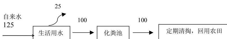
图 2-1 项目水平衡图 (t/a)
